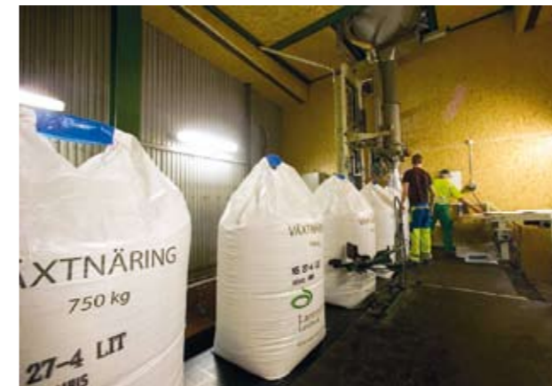
Från båtens lastutrymme till färdigpackad säck på tre minuter. Nordic Bulkens helautomatiska säckfyllningslinje har byggts av Vebe Teknik.
