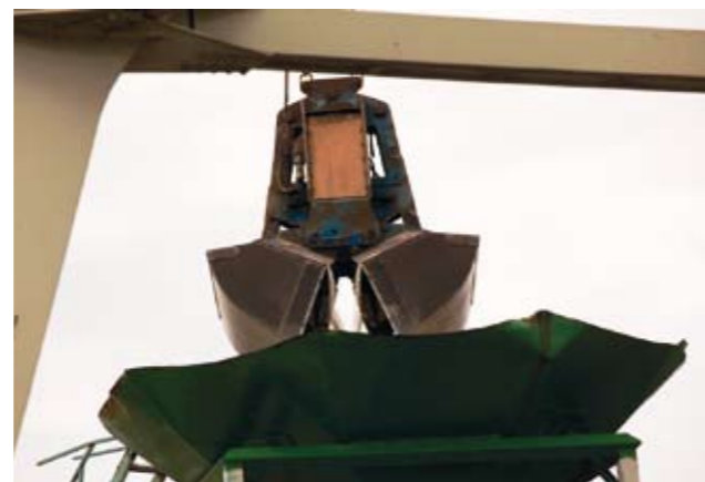
Materialet töms i en tratt och forslas på löpande band direkt till en station för säckfyllning.
